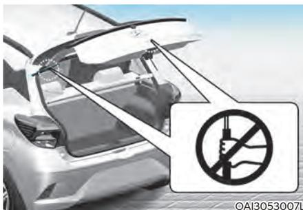
No sostenga la pieza (elevador neumático) que soporta el portón trasero. Tenga en cuenta que la deformación de la pieza puede causar daños en el vehículo y riesgo de accidente de seguridad.
