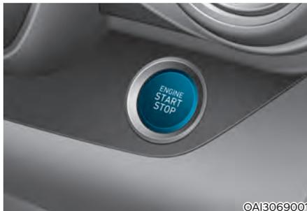
Cuando la puerta delantera está abierta, el botón Start/Stop del motor se ilumina y se apaga 30 segundos después de cerrar la puerta.
