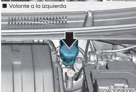
Compruebe periódicamente el nivel de líquido en el depósito. El nivel de líquido debe estar entre las marcas MÁX y MÍN colocadas a un lado del depósito.
