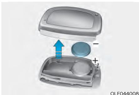
Si la llave inteligente no funciona correctamente, intente cambiar la pila por una nueva.
