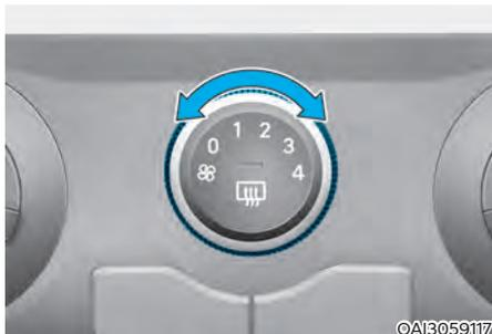
Gire el mando a la derecha para aumentar la velocidad del ventilador y el flujo de aire. Gire el mando a la izquierda para reducir la velocidad del ventilador y el flujo de aire.
