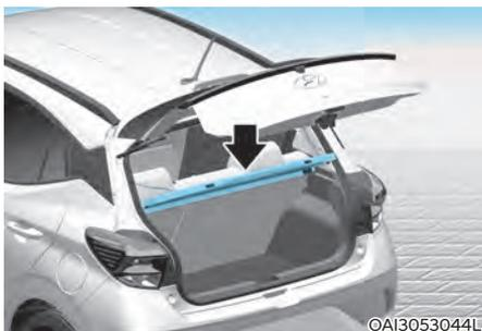
Utilice la cubierta para la zona de carga para ocultar los elementos guardados en la zona de carga.
