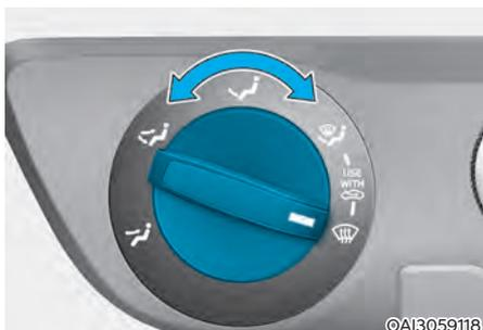
El mando de selección de modo controla la dirección del aire a través del sistema de ventilación.
