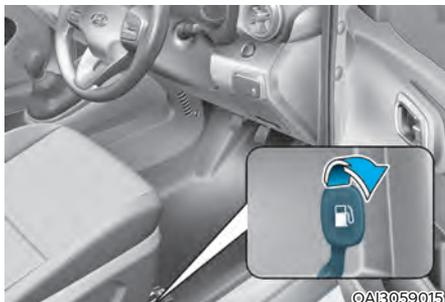
La compuerta de llenado de combustible debe abrirse desde el interior del vehículo tirando de la palanca de la compuerta de llenado de combustible.
