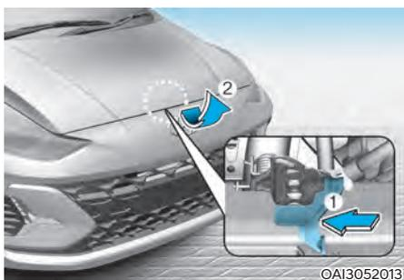
3. Vaya a la parte delantera del vehículo, eleve el capó ligeramente, tire de la palanca secundaria de apertura del capó (1) dentro del centro del capó y levante el capó (2).
