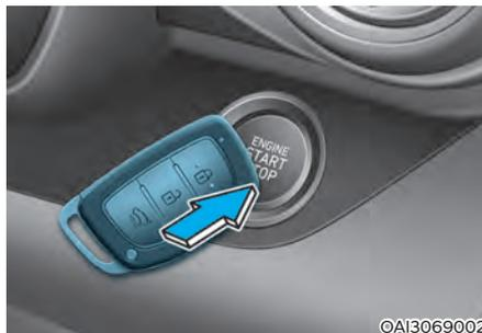
Si la pila de la llave inteligente tiene poca potencia o si la llave inteligente no funciona correctamente, el motor puede ponerse en marcha pulsando el botón de inicio/parada del motor con la llave inteligente en la dirección mostrada en la figura de arriba.
