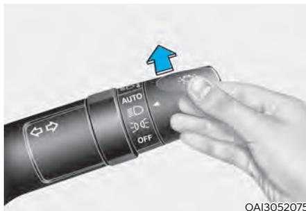
Para encender los faros de las luces de carretera, pulse la palanca hacia fuera. La palanca regresa a su posición original.
