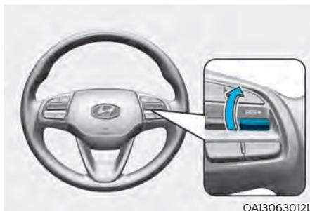
Presione el interruptor RES+ hacia arriba. Si la velocidad del vehículo supera los 30 km/h (20 mph), el vehículo recuperará la velocidad preajustada.
