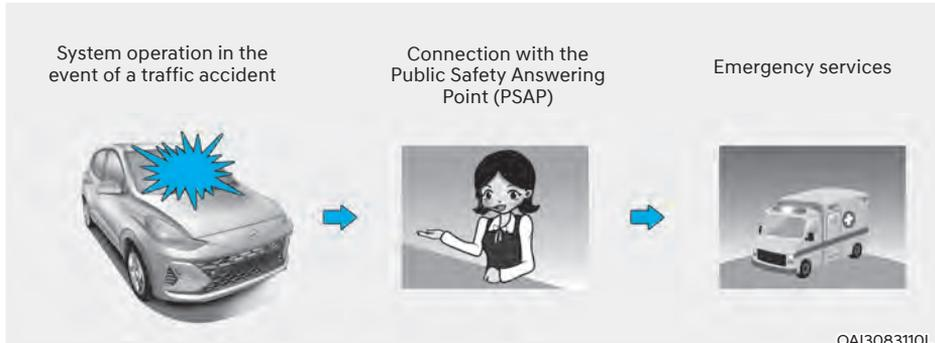
El dispositivo eCall EAU realiza automáticamente una llamada de emergencia al punto de respuesta de seguridad pública (PSAP) con el fin de iniciar las operaciones de rescate pertinentes en caso de accidente del vehículo.
