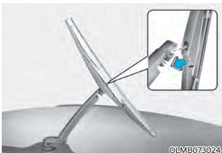
3. Monte un nuevo conjunto de la escobilla colocando la parte central en la ranura del brazo del limpiaparabrisas hasta que encaje en su sitio.
