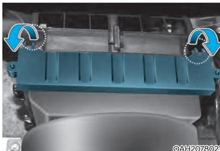
3. Retire la cubierta del filtro del aire de control del climatizador.
