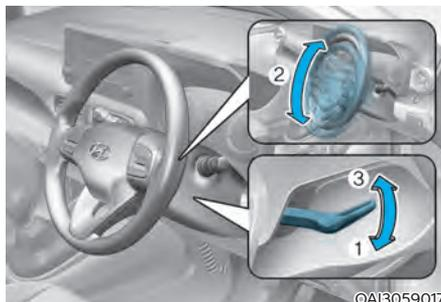
Para cambiar el ángulo del volante:
