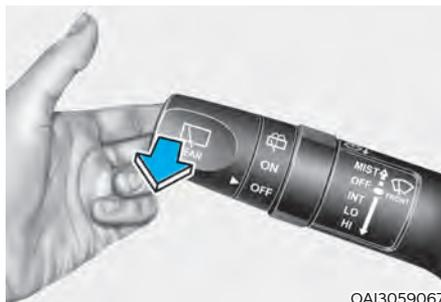
En la posición OFF, tire ligeramente de la palanca hacia usted para pulverizar líquido sobre el parabrisas y accionar 1-3 ciclos de barrido. La operación del pulverizador y el limpiaparabrisas continuará hasta que suelte la palanca.
