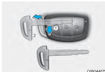
Pulse y mantenga pulsado el botón de liberación (1) y extraiga la llave mecánica (2). Introduzca la llave mecánica en el orificio para la llave en la puerta.
