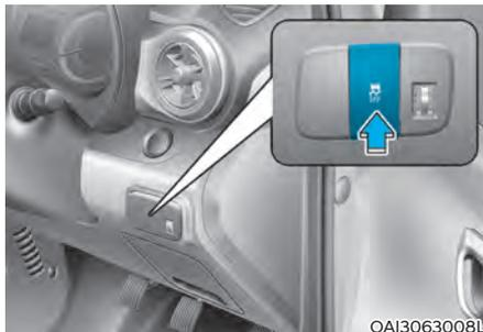
El control electrónico de estabilidad (ESC) permite estabilizar el vehículo durante maniobras en curvas.
