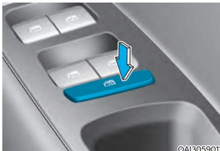
El conductor puede desactivar los interruptores de los elevavinas eléctricos de las puertas de los pasajeros traseros pulsando el interruptor de bloqueo de los elevavinas eléctricos.
