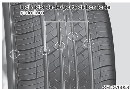
Si el neumático está desgastado de manera uniforme, el indicador del desgaste de la banda de rodadura aparecerá como una banda sólida a lo largo de la banda de rodadura. Esto indica que la banda de rodadura en el neumático es inferior a 1,6 mm (1/16 pulgadas). Reemplace el neumático cuando esto ocurra.
