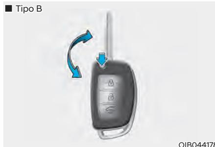
Si la llave a distancia no funciona correctamente, puede bloquear o desbloquear la puerta usando la llave mecánica.
