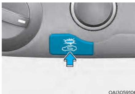
Este botón se emplea para seleccionar la posición de aire (fresco) exterior o la posición de aire recirculado.
