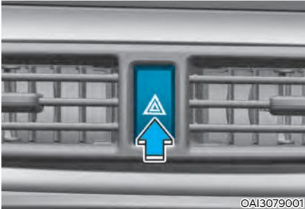
Las luces de emergencia sirven para avisar a los demás conductores que extremen las precauciones cuando se aproximen o adelanten su vehículo.
