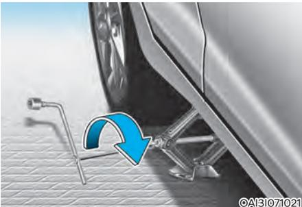
8. Introduzca la manivela del gato en el gato y gírela en sentido horario, elevando el vehículo hasta que las ruedas se separen del suelo. Antes de desmontar las tuercas de las ruedas, asegúrese de que el vehículo se apoye de forma estable sobre el gato.
