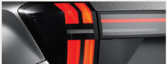
Luces traseras combinadas LED. Incorporan señales de giro y luz de marcha atrás.
